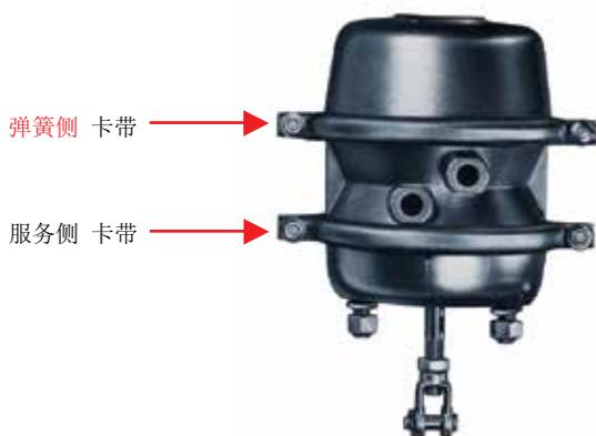
“防破坏” 弹簧制动器
